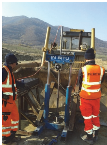
Նկ. 1. CPT սարքը՝ ամրացած բուլդոզերի շերտի վրա
