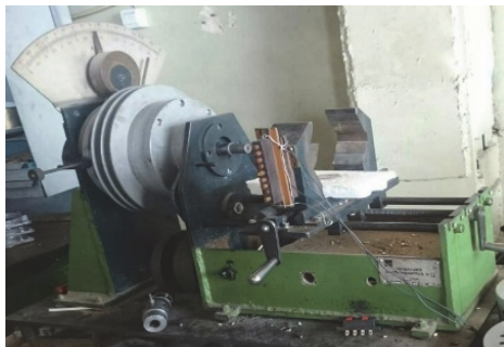
Նկ. 1. Էլեկտրաշարժիչի որակը ստուգող սարք
