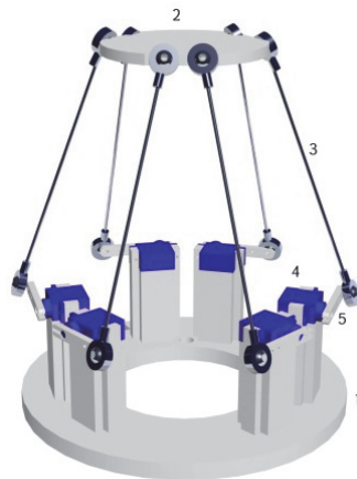
Նկ. 1. Սերվո շարժիչներով ստյուարտի հարթակի կառուցվածքը
