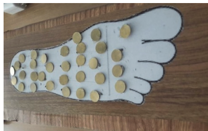
Նկ. 4. Հարթաթաթայությունը որոշող հարթակը
