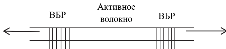
Рис. 2. Схематический вид РБО-лазера. Зеркала – волоконные брэгговские решетки и легированное редкоземельным элементом волокно между зеркалами (активное волокно)
