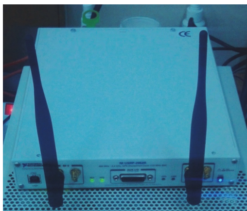
Рис. 2. Примененное оборудование (NI USRP-2952R)
