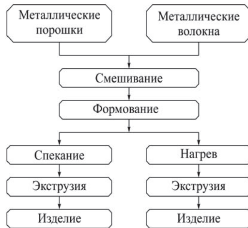
Рис. 4. Технологии получения композиционных материалов экструзией
