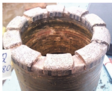
Նկ. Բանեցված թագագլխիկների մաշվածության և բթացման հարթակների տեսքը
