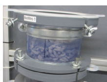
Рис. 2. Биореактор с фильтрующим материалом: а - вид сверху, б- вид спереди
