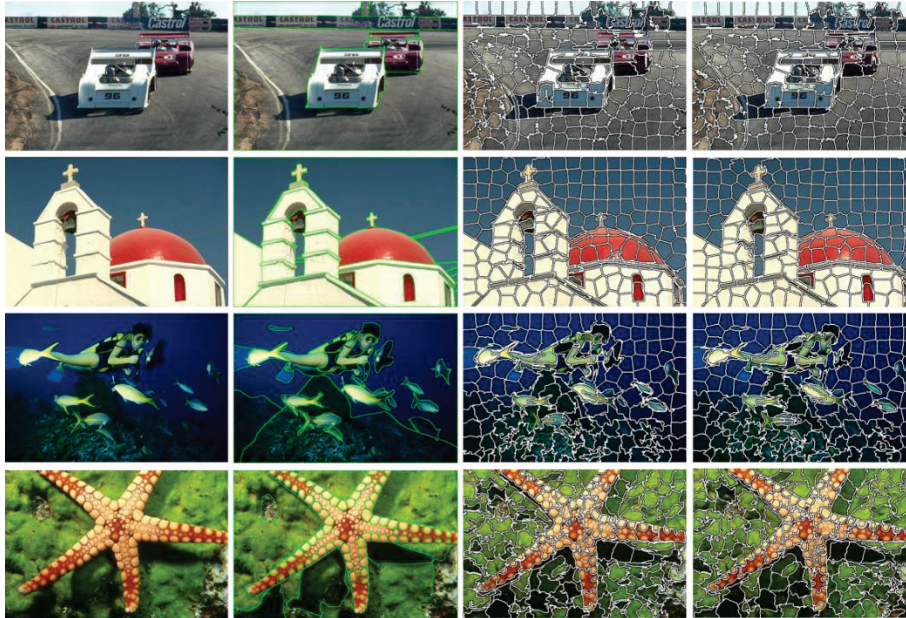
Նկ. 1. Փորձնական արդյունքները. սյուները ձախից աջ. 1.պատկերի բնօրինակը, 2. Պատկերի նմուշային սեգմենտավորումը, 3. SLIC ալգորիթմի կիրառումը CIE76 բանաձևի կիրառմամբ, 4. SLIC ալգորիթմի կիրառումը CIEDE2000 բանաձևի կիրառմամբ
