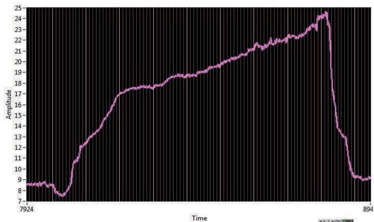
Նկ. 7. Ուժի փոփոխության օսցիլոգրամը անագե խողովակի մամլման ժամանակ
