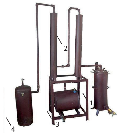
Նկ. 2. Ածխից հեղուկ վառելիքի ստացման փորձարարական տեղակայանքը. 1 - ռեակտոր, 2 - կոնդենսացման աշտարակներ, 3 - հեղուկ վառելիքի ընդունարան, 4 - չկոնդենսացված գազերի հավաքարան
