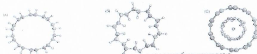
Рис. 1. Схематическое представление вариантов адсорбции водорода в нанотрубках: аркообразная адсорбция (а), зигзагообразная адсорбция (б), молекулы водорода внутри нанотрубки (в).
