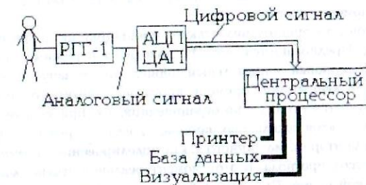
Рис. 1 Архитектура спектрального анализа РГС
