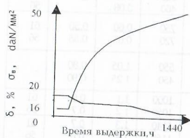
Рис. 1. Влияние естественного старения на механические свойства сплава В95
