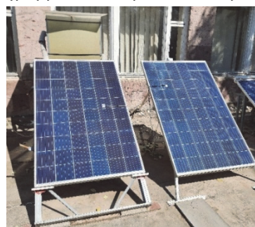
Նկ. 2. Արևային ֆոտովոլտային և ջերմային հիբրիդային մոդուլ (ձախից) և սովորական ֆոտովոլտային մոդուլ (աջից)
