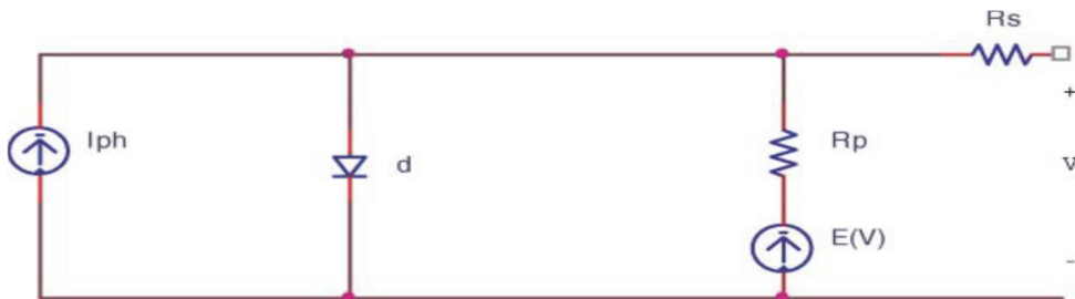
Рис. 2. Эквивалентная электрическая схема согласно модели Бишопа
