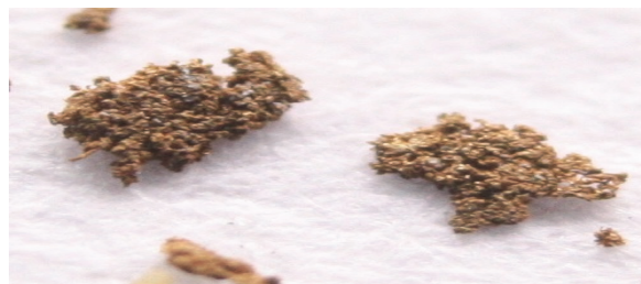
Նկ. 2. Ոսկու սպունգատեսք հատիկները՝ ներծծված պլատինային մետաղների մասնիկներով (խոշորացում՝ \times 200 )
