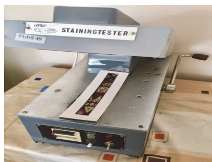
Նկ. Խառնուրդային գործվածքների մաշակայունության որոշման համար նախատեսված FD-17A սարքավորումը
