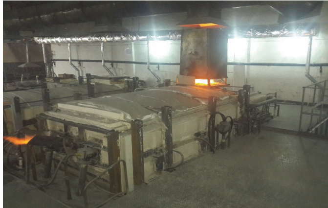
Նկ. 1. «ԱՐՄԲԱԶԱԼՏ» ՓԲԸ-ի բազալտի հալույթի վառարանը
