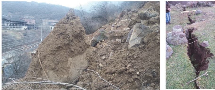
Նկ. 3. Թումանյանի սողանքի լեզվակն ու վերևում բացված ճաքերը (աջ կողմի նկարում երևում են տեղադրված փարոսիկները)
