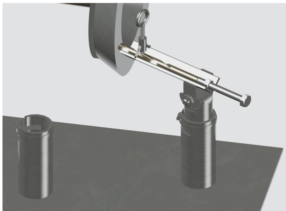
Նկ. 4. Բազմաստիճան սայրով պարուրածն գայլիկոնի սրման հարմարանքի դիրքը նախնական սրման ժամանակ
