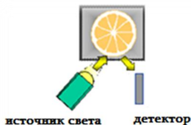
Рис. 2. Метод измерения отражения
