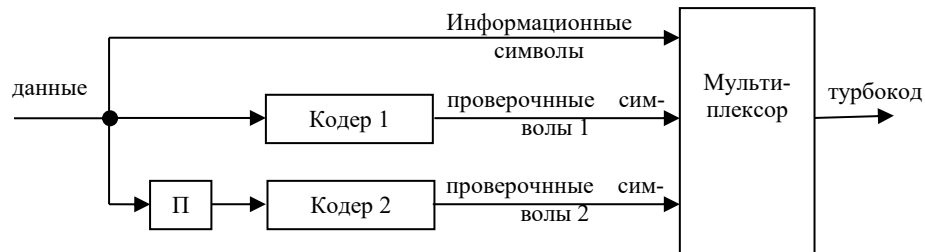
Рис. 4. Развернутая параллельная схема турбокода
