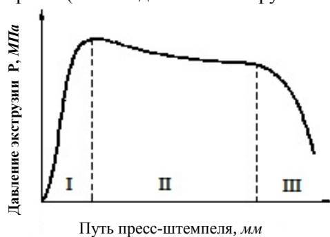
Рис. 2. Изменение суммарного давления в пуансоне при разных стадиях (I, II, III) прессования с прямым истечением
