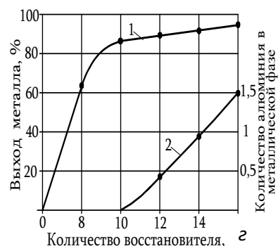
Рис. 4. Зависимость выхода металла (1) и содержания в нем количества алюминия (2) от количества восстановителя, %
