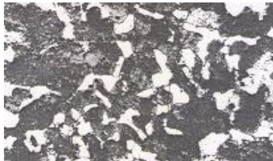
Рис. 5. Форма зерна мартенситно-старееющего стального порошка Марки ПС-Н18К10М5Re ( \times 100 )
